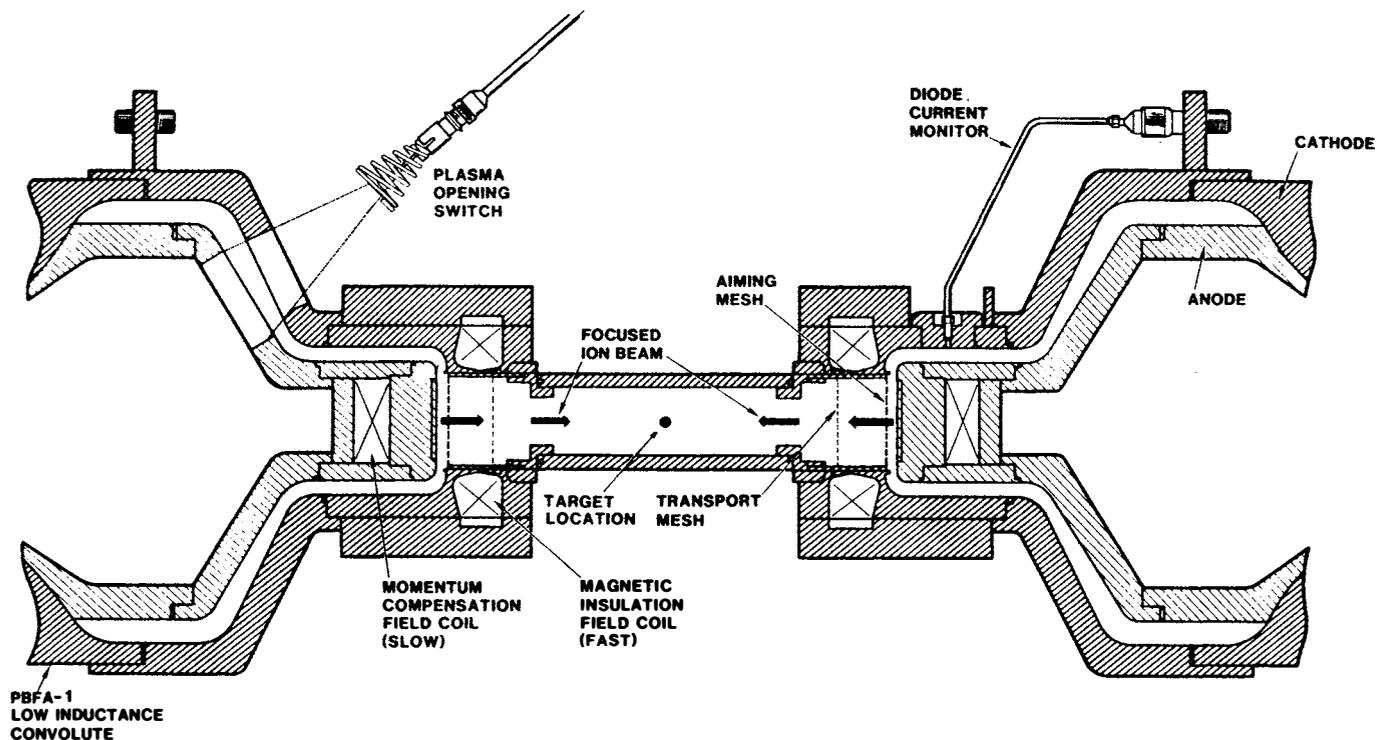
**CROSS SECTION OF DIODE**
