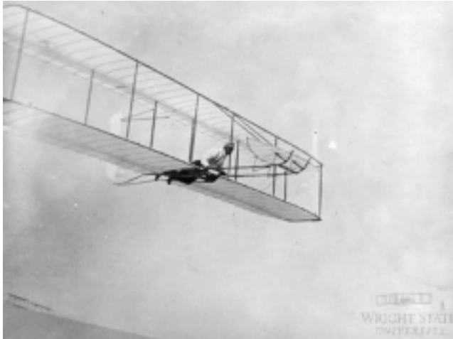
Wilbur Wright tendido en el planeador de 1902, inmediatamente después de un aterrizaje. Pueden verse las rastras del patín atrás de la nave. Las que aparecen en el primer plano son de un aterrizaje previo. (Foto: Library of Congress).
