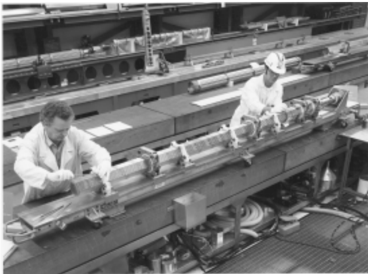
Técnicos de FFTF trabajan en el ensamblaje de barras de combustible nuclear en 1986. (Foto: Departamento de Energía de EU).
