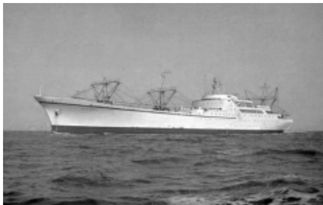
El NS Savannah fue el primer buque nuclear de carga y pasajeros, producto del optimismo del proyecto Átomos para la Paz, y puede circunnavegar la Tierra 14 veces sin reabastecerse de combustible. (Foto: Administración Marítima de EU).
